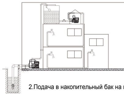
Примеры установки: 1. Непрямая подача из бака
